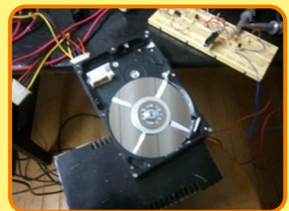
Disco rígido en desus utilizado para medir velocidad de rotacion
