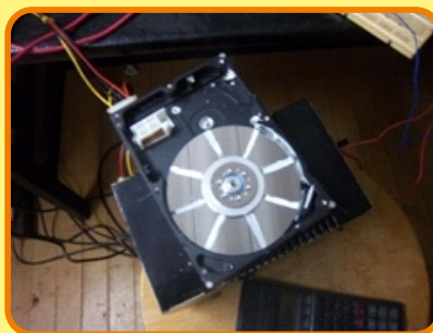
Disco rígido en desus utilizado para medir velocidad de rotacion
