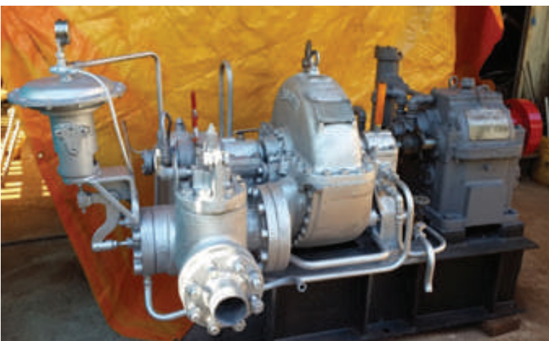
Turbina de vapor con la caja reductora de velocidad y sistemas auxiliares
